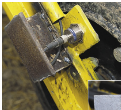
Als Spornrad dient der Nachläufer. Ein Steuerungskontakt für den Saatgutfluss wird von einem Kontakt an der Aufhängung der Walze beim Ausheben bzw. Absenken des Gerätes betätigt.
