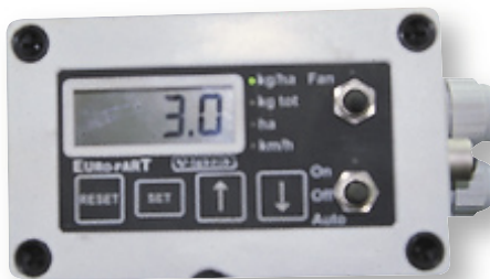
Die intuitive Bedienung der Sämaschine erfolgt über den mitgelieferten Bordcomputer.
