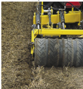
Jede gängige Walze ist montierbar. Dem Gerät fehlt eine Seitenbegrenzung, das führt zu nicht bedeckten und rückverfestigten Erdspalten.
