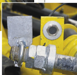
Als Spornrad dient der Nachläufer. Ein Steuerungskontakt für den Saatgutfluss wird von einem Kontakt an der Aufhängung der Walze beim Ausheben bzw. Absenken des Gerätes betätigt.
