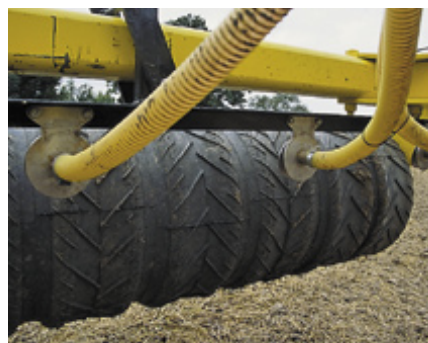
...die Saatschläuche enden an Pralltellern, das Saatgut wird in Breitsaat ausgebracht.
