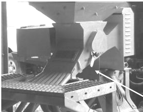
Bodenklappe muss geöffnet werden können.
