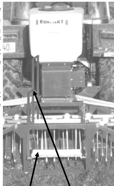
Aufstieg und Handlauf
