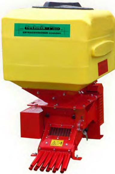
**12 Auslässe DM25mm; KTL Pulverbeschichtung, 12 Prallteller verzinkt; 30m biegsamer Spiralschlauch DM 25mm; wahlweise 130-, 200-, 300-, 400-Liter Kunststoffbehälter (transparent) mit eingravierter Literskala bzw. Deckel mit Drehverschluss; inkl. Gebläse; verstellbare Bodenklappe; Rührwelle; Säwellen für verschiedene Einsätze: Standardsäwelle, Metallsäwelle; elektrischer Säwellenmotor mit 1 Geschwindigkeit;**
